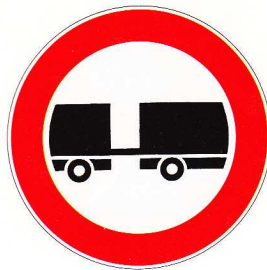
Figura II 61 Art. 117 TRANSITO VIETATO AI VEICOLI A MOTORE TRAINANTI UN RIMORCHIO Vieta il transito a tutti i veicoli a motore trainanti un rimorchio.
