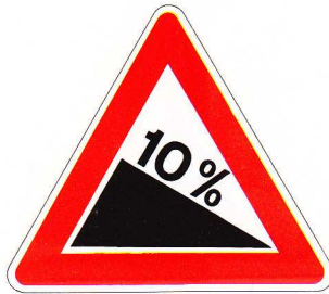
Figura II 15 Art. 89 DISCESA PERICOLOSA Presegnala una discesa pericolosa in conseguenza di fattori locali particolarmente sfavorevoli. La pendenza è espressa in percentuale.
