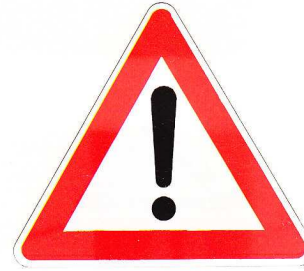
Figura II 35 Art. 103 ALTRI PERICOLI Presegnala un pericolo diverso da quelli indicati negli altri segnali di pericolo. È obbligatorio un pannello integrativo modello II 6 recante un simbolo od una iscrizione che precisi la natura del pericolo.
