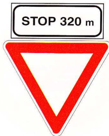
Figura Il 39 Art. 108 PREAVVISO DI FERMARS E DARE PRECEDENZA Presegnala la successiva presenza di un segnale FERMARS E DARE PRECEDENZA (STOP) indicando anche la distanza dall'intersezione.
