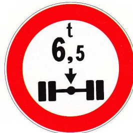
Figura II 69 Art. 118 TRANSITO VIETATO AI VEICOLI AVENTI MASSA PER ASSE SUPERIORE A ... TON. Vieta il transito ai veicoli aventi sull'asse più caricato una massa superiore a quella indicata.
