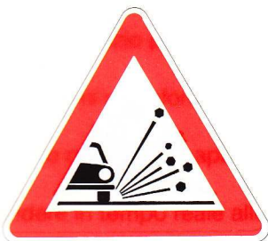
Figura II 29 Art. 98 MATERIALE INSTABILE SULLA STRADA Presegnala la presenza sulla pavimentazione di ghiaia, pietrisco, graniglia, od altro materiale instabile che può diminuire pericolosamente l'aderenza del veicolo od essere proiettato a distanza.
