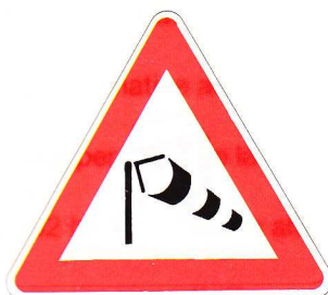
Figura II 33 Art. 101 FORTE VENTO LATERALE Presegnala un tratto di strada soggetto a possibili forti raffiche di vento, come su viadotti, uscite di gallerie, fine trincee, e situazioni simili.
