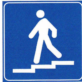
Figura II 306 Art. 135 SOTTOPASSAGGIO PEDONALE Localizza un sottopassaggio per l'attraversamento stradale solo per i pedoni.
