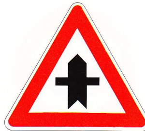
Figura Il 43/a Art. 112 INTERSEZIONE CON DIRITTO DI PRECEDENZA Presegnala un'intersezione nella quale il conducente ha la precedenza sui veicoli provenienti dalle strade subordinate.
