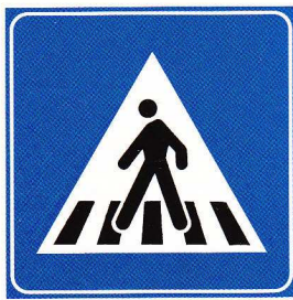
Figura II 303 Art. 135 ATTRAVERSAMENTO PEDONALE Localizza un attraversamento pedonale non regolato da semaforo e non in corrispondenza di intersezioni.
