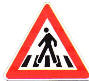
Figura II 13 Art. 88 ATTRAVERSAMENTO PEDONALE Presegnala un attraversamento contraddistinto da appositi segni sulla carreggiata, sulle strade extraurbane e su quelle urbane con limite di velocità superiore a quello stabilito dall'art. 142, comma 1, del codice.
