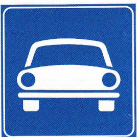
Figura II 314 Art. 135 STRADA RISERV. AI VEICOLI A MOTORE Indica l'inizio di una strada, diversa dall'autostrada, riservata ai veicoli a motore. Dev'essere posto in corrispondenza di tutti gli accessi a tale strada. Il segno sostituisce tutti i segni di divieto riferiti ai veicoli senza motore.
