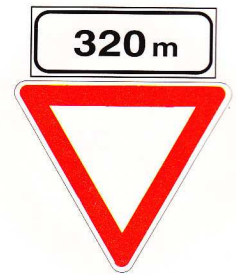
Figura Il 38 Art. 108 PREAVVISO DI DARE PRECEDENZA Presegnala la successiva presenza di un segnale DARE PRECEDENZA, indicando anche la distanza dall'intersezione.
