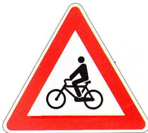
Figura II 14 Art. 88 ATTRAVERSAMENTO CICLABILE Presegnala un attraversamento ciclabile contraddistinto da appositi segni sulla carreggiata, sulle strade extraurbane e su quelle urbane con limite di velocità superiore a quello stabilito dall'art. 142, comma 1, del codice.
