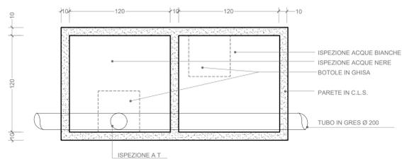
PIANTA POZZETTI D'ISPEZIONE 1:25
